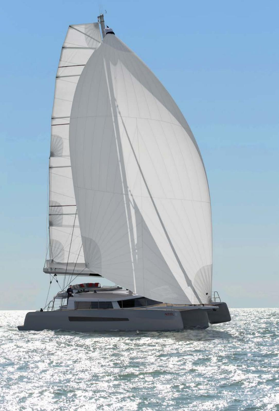
**L**e plan de voilure est constitué d'une Grand-Voile (avec 3 ris) et d'une trinquette sur emmagasineur (sur câble structurel intégré dans la voile).
