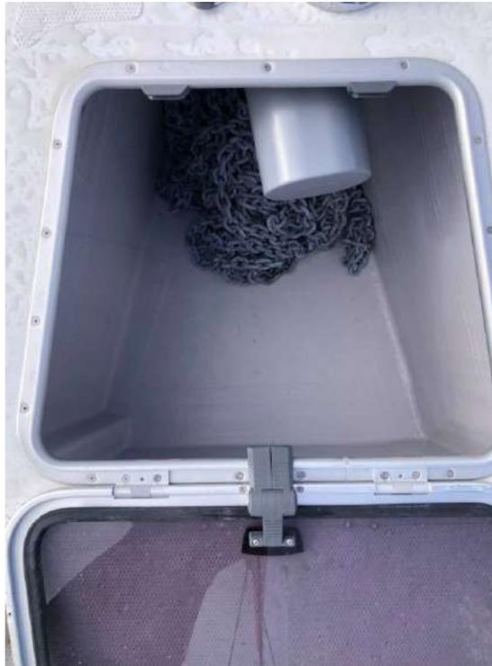
**Profonde baille à mouillage et accès au propulseur d'étrave à l'avant du flotteur central**
